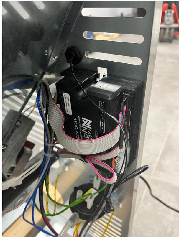
IL SUFFIT DE LEVER LES 2 FIXATIONS METALIQUE DE LA CARTE A L'AIDE D'UN TOURNEVISSE PLAT ET DE DEBRANCHER TOUS LES CABLES BRANCHER SUR CETTE DERNIERE
