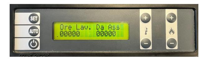
Appuyer le + de la température et - de la température simultanément, jusqu'à ce que les heures de travail arrivent à 0
